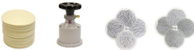
**МТ 379** Прибор для испытания шерстяных тканей и трикотажных полотен на стойкость к истиранию (типа ТИ-1М) по ГОСТ 9913-90
