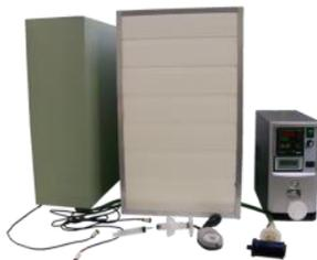
**MT 164 Прибор для определения фильтрующей способности нетканых материалов и размера пор ISO 12956-1999**
