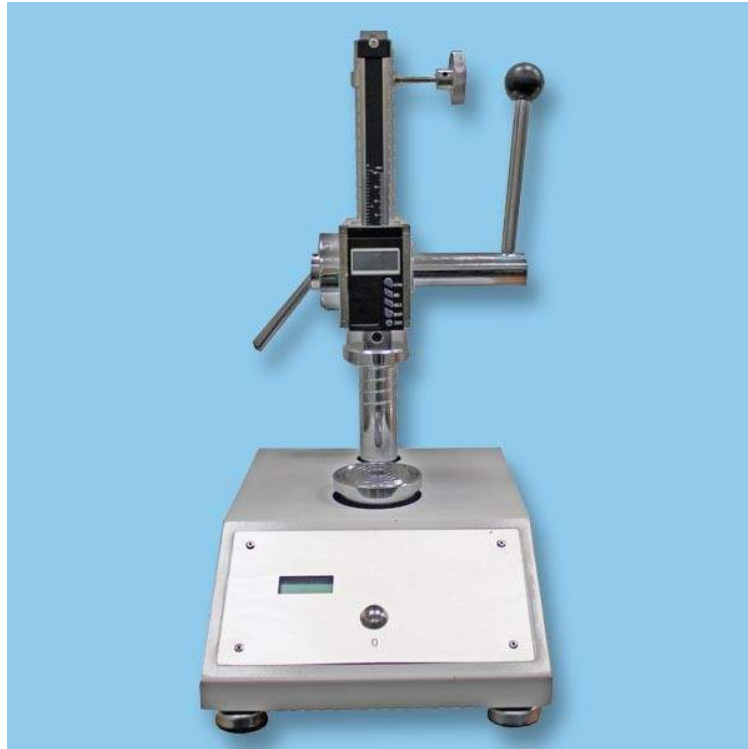
Устройство используется для проверки упругости пружин. Устройство может быть применено к тестированию рабочей нагрузки расширения и сжатия пружин при сжатии пружины до заданной длины.
