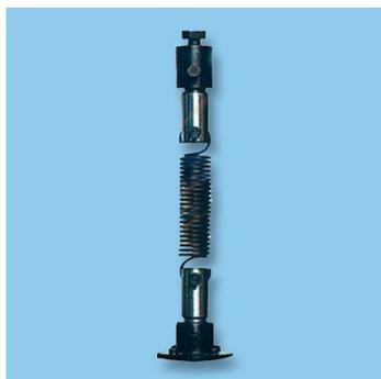
Зажимы для измерения растяжения пружины
