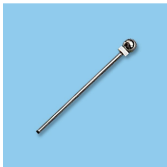
Испытательный щуп - цилиндр со сферическим концом диаметр 12мм, длина 80мм. ГОСТ МЭК 60950-1, MT 221
