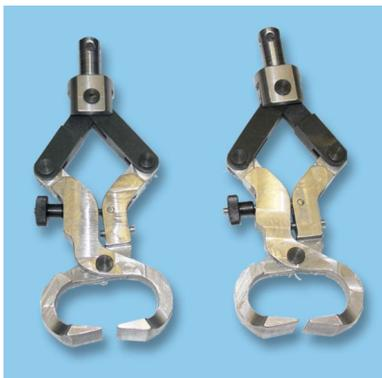
Приспособление к разрывной машине для определения прочности подошв гвоздевого, винтового, деревянно-шпичечного, пошивного креплений по ГОСТ 9134-78
