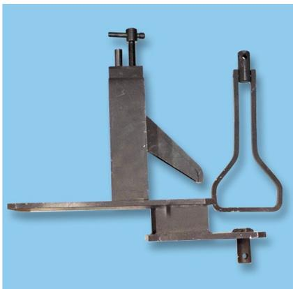
Приспособление к разрывной машине для определения гибкости обуви по ГОСТ 9718-88
