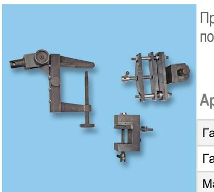
Приспособление к разрывной машине для определения прочности крепления подошв в обуви химических методов крепления по ГОСТ 9292-82
