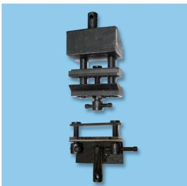
Приспособление к разрывной машине для определения прочности крепления ранта и стельки по ГОСТ 9134-78
