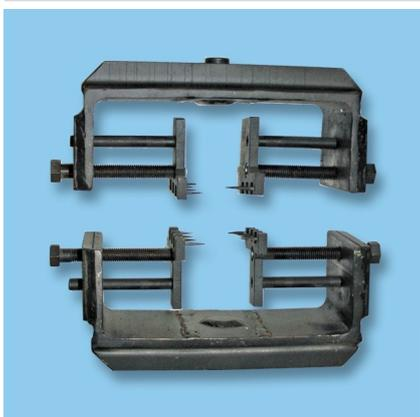
Приспособление к разрывной машине для определения прочности клеевого и гвоздевого крепления низкого каблука и набойки по ГОСТ 9136-72
